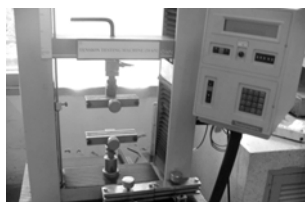
วัดแรงดึงด้วยเครื่องวัดแรงดึง (Tension Testing Machine)
