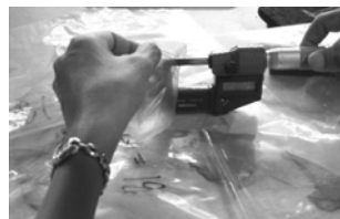
วัดความหนาด้วยเครื่องวัดความหนา (Vernier) ชนิด micro meter
