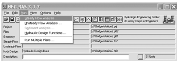
รูปที่ 11 เลือกการคำนวณผลการไหลของน้ำแบบสมำเสมอ
