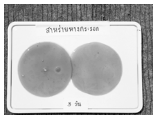
ผึ่งให้แห้งสนิทก่อนนำไปวัดความหนาและแรงดึง
